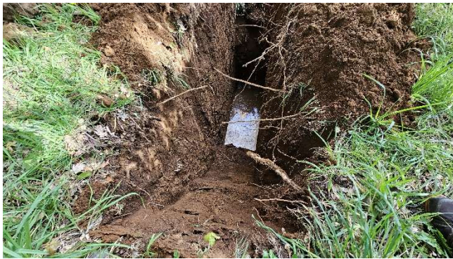
Figura 2.4: Ejecución de calicata C-3.
