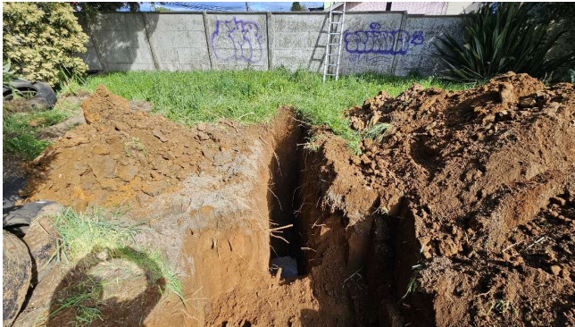
Figura 2.3: Ejecución de calicata C-2.
